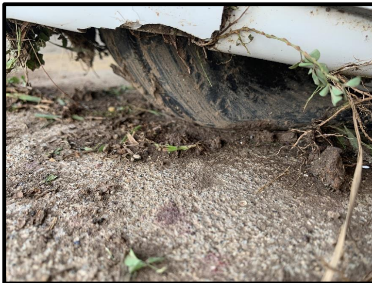
Fotografía No. 4 Rueda del tren de nariz, desinflada por el impacto.
