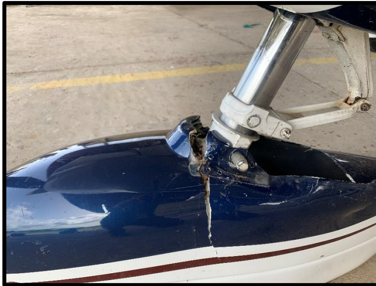
Fotografía No. 3 Vista de los daños en el tren de nariz.
