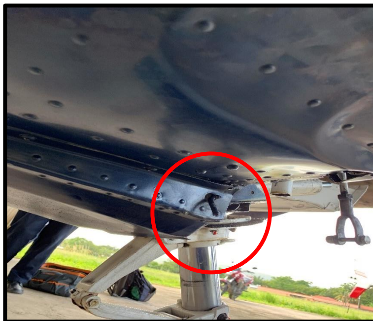
Fotografía No. 12 Vista cercana de los daños en el soporte del tren de nariz en la pared de fuego.
