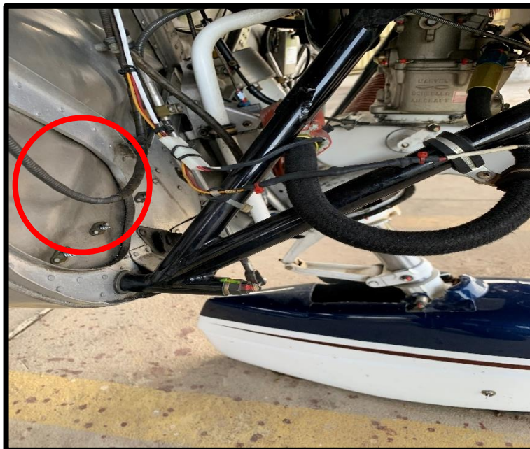
Fotografía No. 10 Daños en la parte inferior de la pared de fuego.
